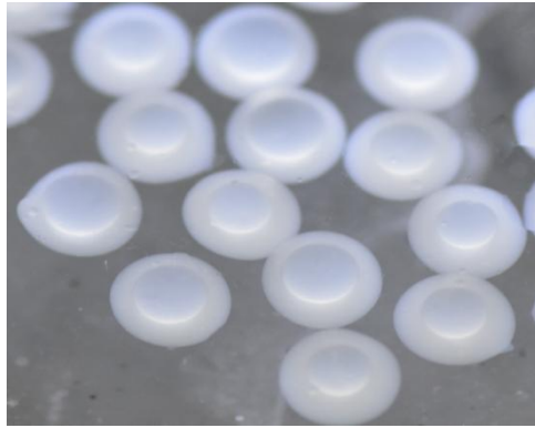
Rys. 3. Kapsułki utworzone metodą koaksjalną (płaszcz: 3% roztwór alginianu sodu, rdzeń: olej rzepakowy, roztwór sieciujący: 3% \text{CaCl}_2 )
